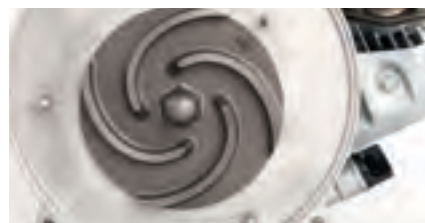
WB-sortimentet har ett högeffektivt pumphjul med 4 lameller
