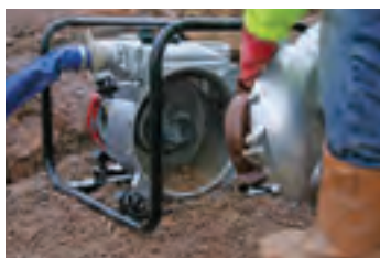
Den avtagbara inspektionsluckan ger snabb enkel åtkomst
